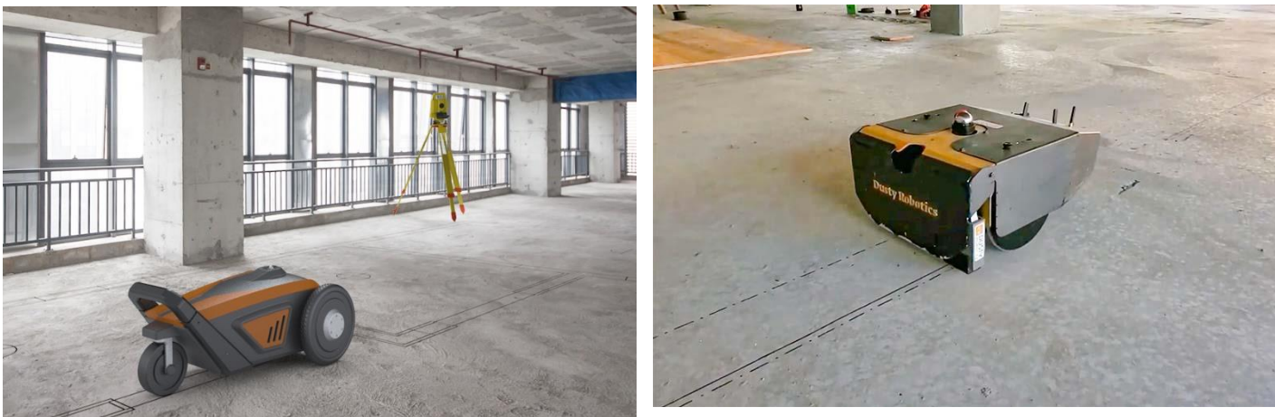
Рис. 2. Полевой принтер автоматизирует разметку здания
